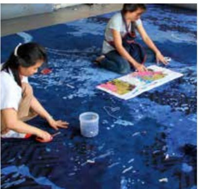
Endkontrolle mit Überprüfung der Polhöhe
